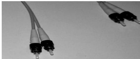
*Svjetlovodni kabel s odgovarajućim konektorom (tip ST)*
