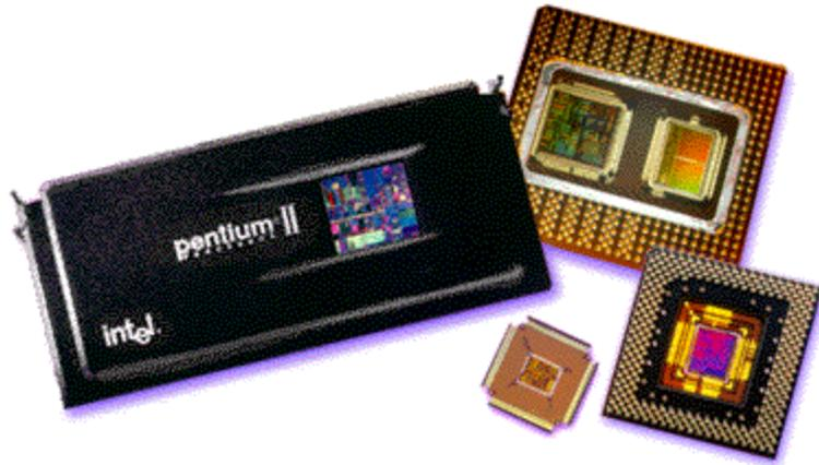
**Mikroprocesorski ip se lijepi na donji dio plasti nog ku išta, a kontakti se pomo u tankih žica povezuju sa nožicama (pinovima) ku išta**
