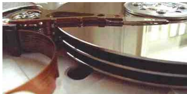
Slika br. 7 – unutrašnjost Hard diska s diskovima i magnetskom glavom za čitanje i pisanje
