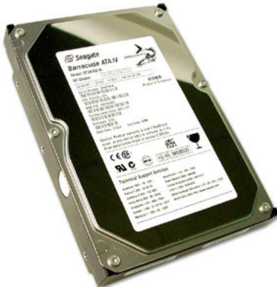
**HardDiskDrive** (dalje: HDD) je jedini mehanički dio mikroRačunala. Naravno vremenom je na HDD-ove dodana elektronika kako bi se što više ubrzao rad. Ta činjenica da ipak najvažniji dio HDD (pohranjivanje i čitanje podataka) radi na mehanički način daje mu titulu najčešće pokvarenog dijela mikroRačunala uopće.
