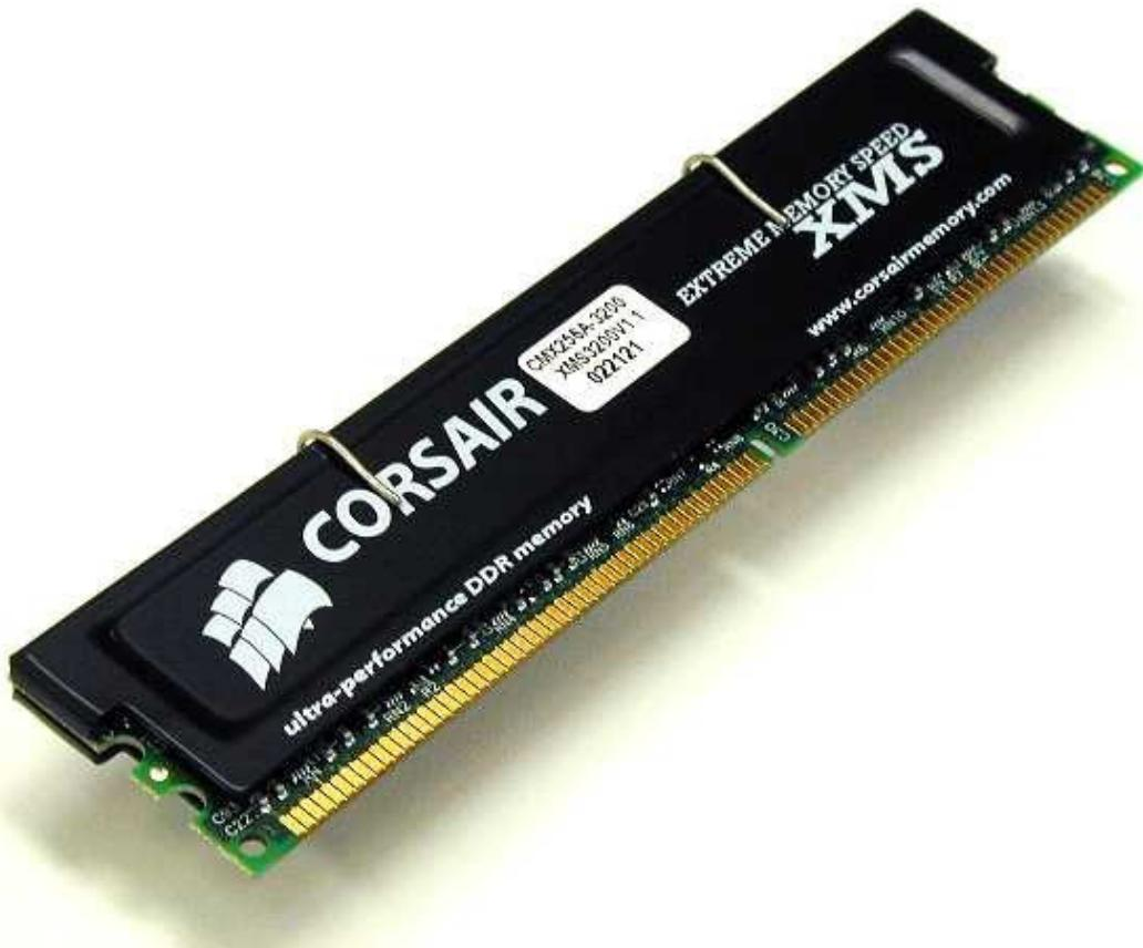
Procesor za vrijeme rada konstantno pristupa radnoj memoriji (RAM). Performanse samog računala uvelike ovise o brzini memorije RAM. Također, brzina ne znači ništa ukoliko računalo posjeduje malo memorije. Dakle, da bi osigurali najbrži moguć rad računala opremite ga s najbržom memorijom koju platforma podržava te nemojte štediti na količini. Zbog same uske povezanosti procesora s memorijom i najmanji kvar u memoriji uništiti će stabilnost računala.
